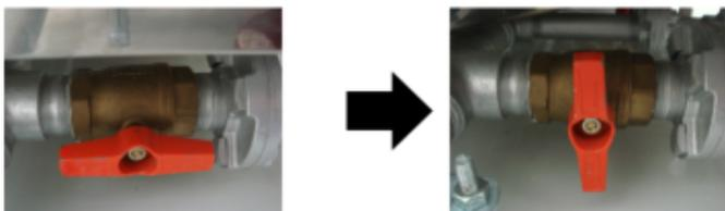
3. A, B水槽のバルブ（図1-A, B）を開け水を溜める。
